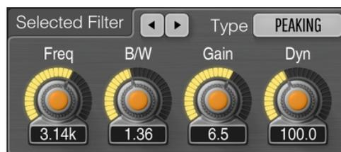
Ce panneau vous permet de régler avec précision les paramètres du seul filtre sélectionné. Avant de pouvoir l'utiliser, vous devez sélectionner un point de contrôle dans le panneau "EQ", ou utiliser les boutons de défilement adjacents pour sélectionner le filtre requis.
