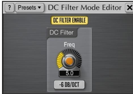
In diesem Fenster können Sie Einstellungen für das DC-Filter vornehmen sowie Benutzereinstellungen abspeichern. Das DC-Filter ist die letzte Instanz in der Signalkette. Zweck des DC-Filters ist es, unerwünschte Tieffrequenzanteile zu entfernen, die durch andere Bearbeitungsschritte des Plugins entstehen können.
