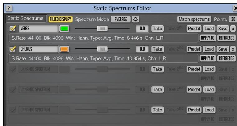
Manche Equalizer-Plugins von Voxengo verfügen über die Darstellung eines statischen Spektrums, welches über das oben abgebildete Editor-Fenster konfiguriert werden kann. Hier können Sie den Namen des Spektrums, seine Farbe und den Versatz in Dezibel des statischen Spektrums bestimmen. Mithilfe der Checkboxes
