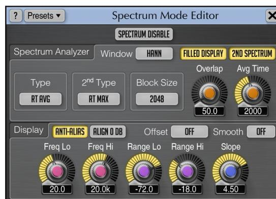
Mit dem „Bypass“-Schalter oben in der Titelzeile kann die Spektrumanalyse-Funktion des Plug-Ins komplett deaktiviert werden.
