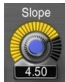
Ein Drehregler besteht aus vier Bereichen: dem Namen des gesteuerten Parameters, der Reglerpositionsanzeige, dem Drehregler selbst und der Parameterwertanzeige.
